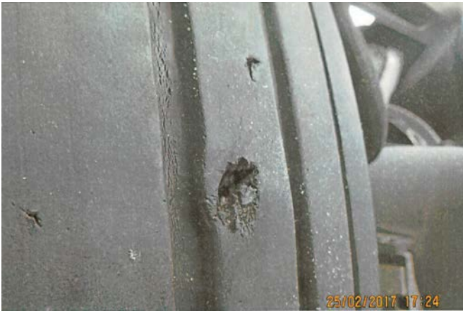
Фото 1. Повреждения авиационного колеса правой опоры шасси самолета Б-777-200 25.02.2017
