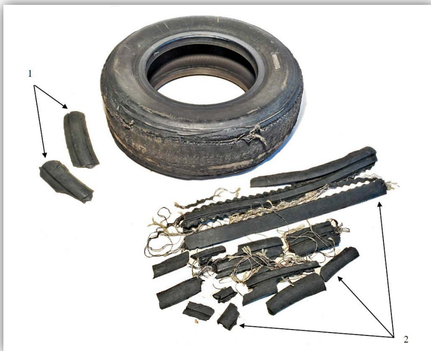
Фото 2. Общий вид разрушенной авиационной, фрагменты обнаруженные на аэродроме вылета (1) и аэродроме прилета (2)
