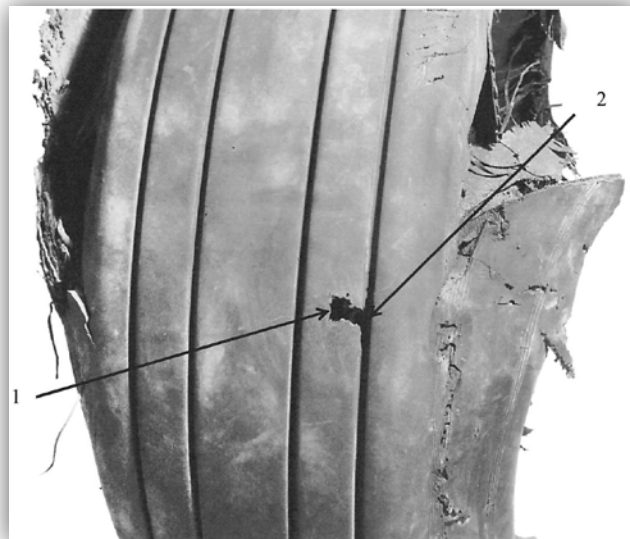
Фото 1. Разрушение размером 2,0×1,5 см от наезда на посторонний предмет (1) и трещина на дне канавки длиной 5 см рядом с местом разрушения от наезда на посторонний предмет (2)
